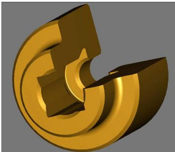
**Figura N°12-** Esecuzione di un attacco interno quadro su un mozzo
