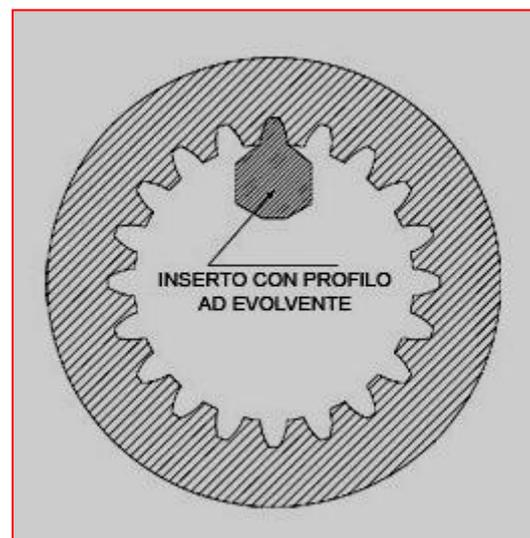
**Figura N°8** – *Esecuzione di una dentatura interna di  $M=2$  ;  $Z=20$  ;  $AP=20^\circ$*
